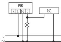
Lors du branchement d'inductances parallèles au réseau (lampes fluorescentes, contacteurs, etc.), un conduit RC peut être nécessaire.
